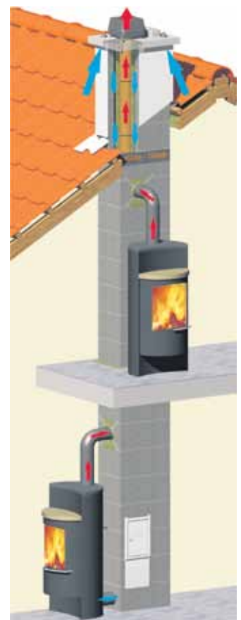
Das Schema verdeutlicht eine Mehrfachbelegung des Schornsteins. Grafik: TONA
