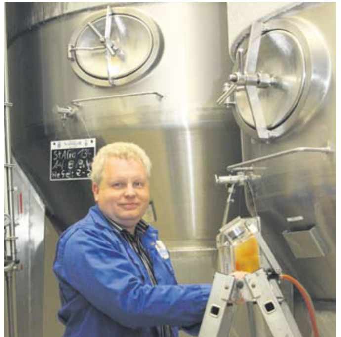
Braumeister Bernd Heitmann bei der Kontrolle des Kohlendioxidgehalts im Gärtank. Foto: Jürgen Birkhahn
