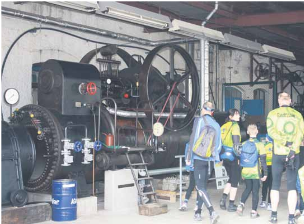
Die stationäre Lokomobile wurde 1935 gebaut und diente zum Antrieb der Späneabsaugung und eines Generators zur Erzeugung von elektrischem Strom.
