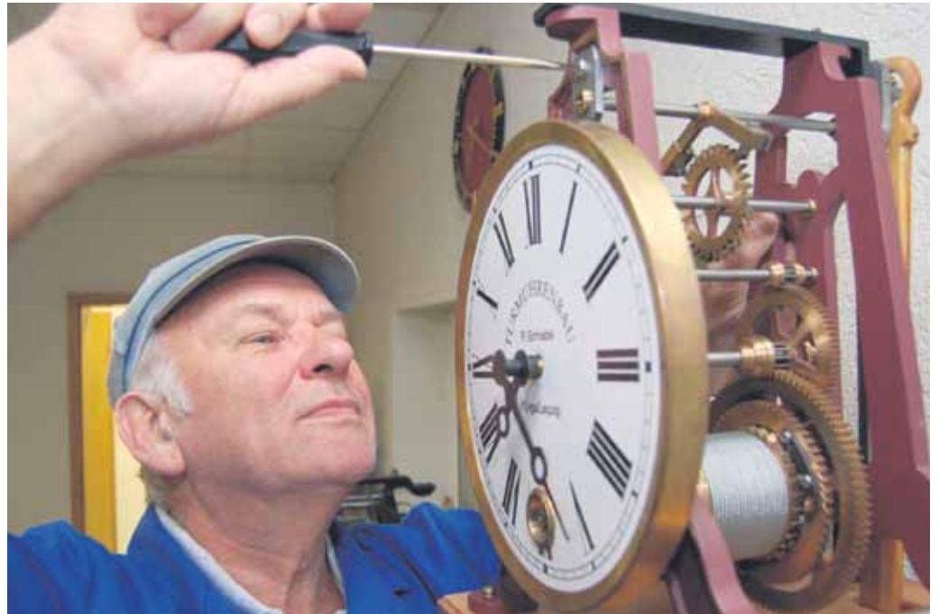
Wei, was die Stunde geschlagen hat: Peter Schnabel bei der Reparatur eines mechanischen Turmuhrwerkes.
